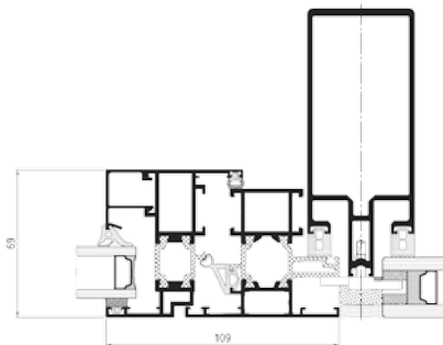
przekrój przez okno otwierane w fasadzie
